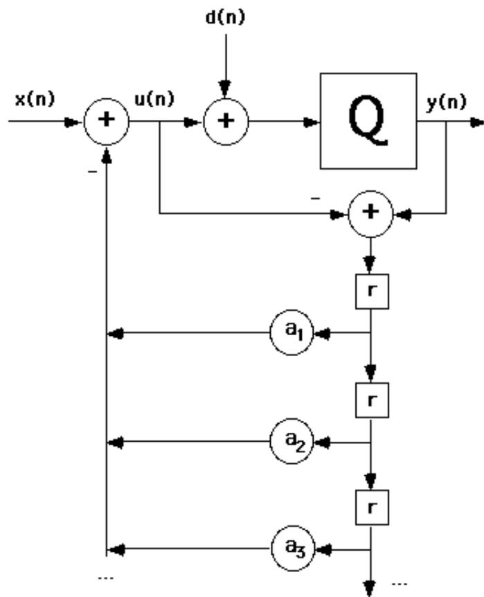
Con un po' di matematica (la teoria della **trasformata Z**) si ottiene la funzione di trasferimento del sistema  $Y(z)$  e la potenza del rumore totale  $G$ :
